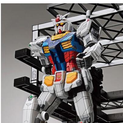
矗立於橫濱山下碼頭的「RX-78F00 鋼彈」造型與過去的初代鋼彈設計有相當大的差異，由於必須讓它動起來，除了強度還必須考量到如同遊樂設施的可動設計，而鋼彈的裝甲造型也必須配合整體配重、移動方式進行調整，對比台場鋼彈相對還原設定的造型，橫濱鋼彈將頭部、背包小型化。同時也參考了富野由悠季導演提供的建議，視覺上體型更加修長、較近似近年來推出的新鋼彈。
